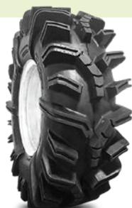
Шины разработаны специально для техники, участвующей в гонках по грязи. Очень глубокий рисунок протектора гарантирует отличные тяговые характеристики в условиях сложнопроходимых трасс. Боковая защита шин снижает негативное ударное воздействие и степень возможных повреждений. Шины отличаются исключительной прочностью (норма слоистости: 6).
